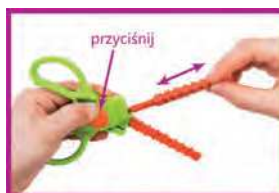
Przyciśnij przycisk aby zmienić ostrze.
